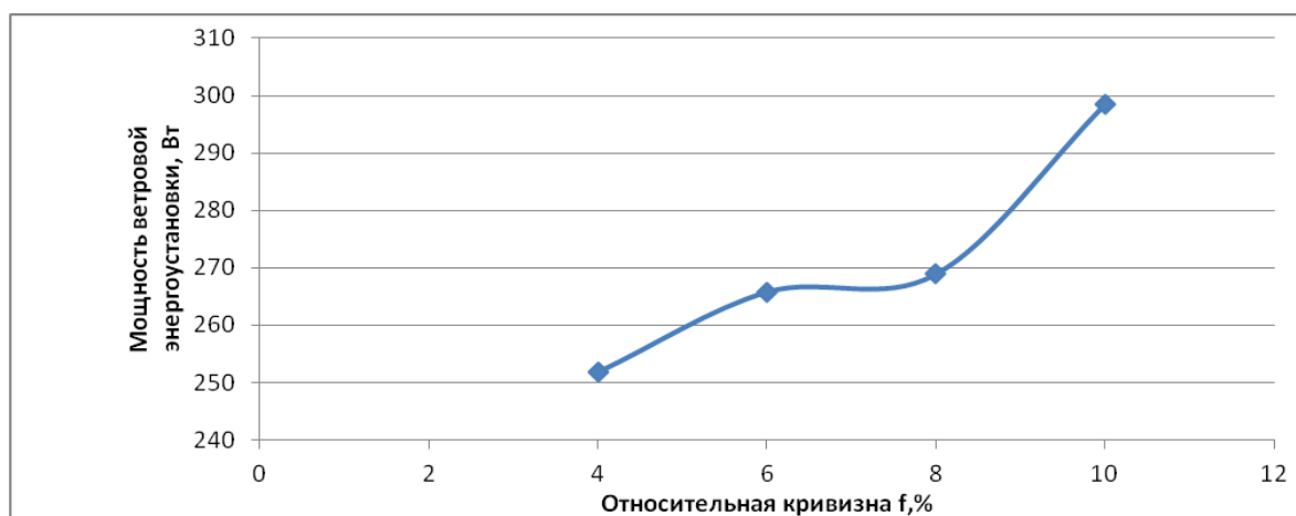
Рис. 9. Зависимость максимальной мощности энергоустановки (P) от относительной кривизны при относительной толщине профиля 2%
